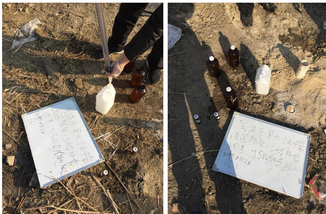
图 4-7 地下水采样照片
